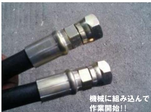
当社常設の加締め機「UC25QC」が規定圧力でホースと口金具を確実に加締めます。
